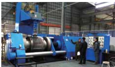
YFB-D40"600LB(带扭矩测试)阀门试验台客户调试现场
