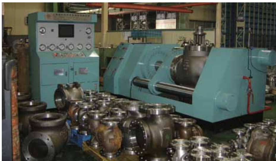
DN500 带伺服控制系统顶压式阀门试验台客户使用现场
