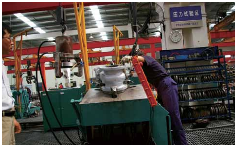
DN300 单头抱压式阀门试验台客户使用现场
