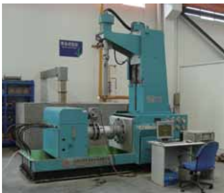
DN300 阀门寿命试验机客户使用现场
