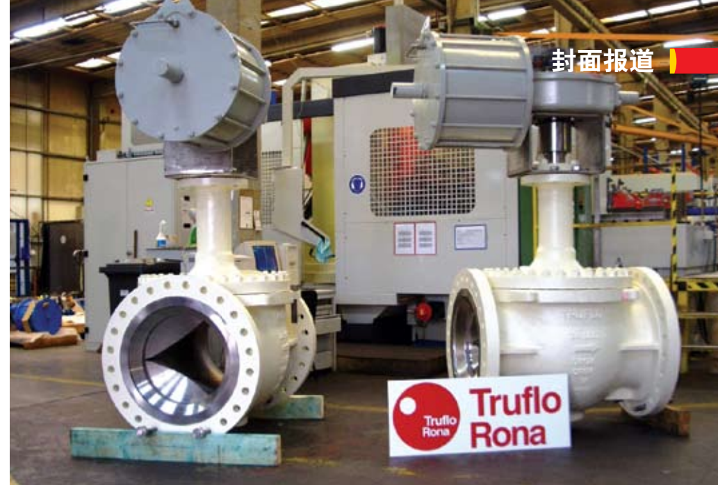
Truflo Rona 上装式低温控制球阀，双偏心旋转。
