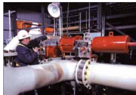
冷湖（Cold Lake）油砂设施中的 GP 系列直角行程故障保护气压执行器。
